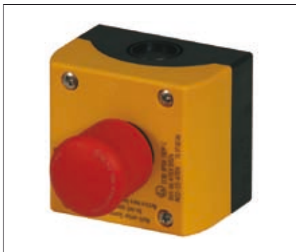
Obr. 2. Větší uplatnění v průmyslových aplikacích nachází tlačítka nouzového zastavení ze sortimentu RMQ-Titan (montážní otvor 22 mm); jsou k dispozici jako prosvětlená či bez prosvětlení, s ovládacím klíčem, s odaretací pootočením či povytažením
